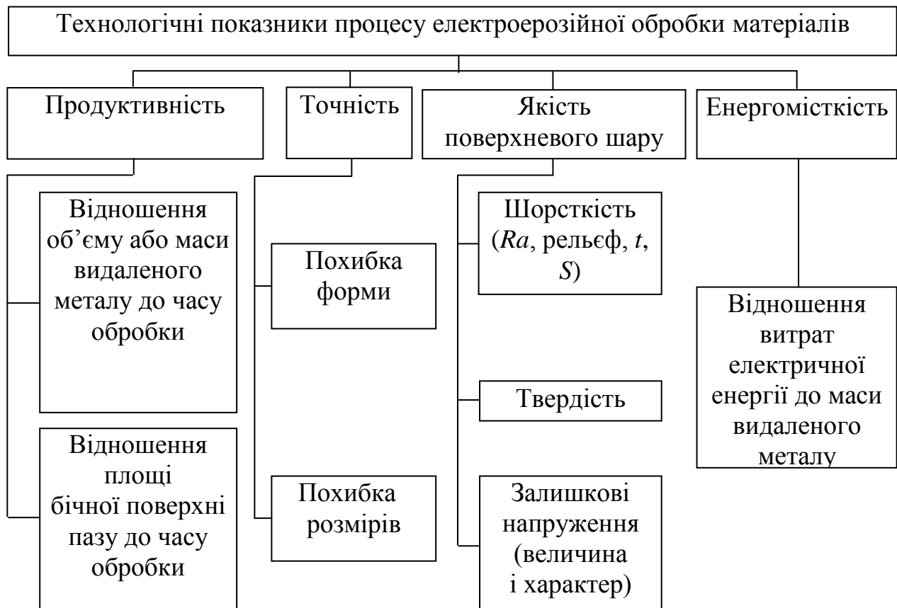
Рисунок 3.1 – Структурна схема управління процесом електроерозійної обробки матеріалів
